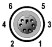
Рисунок Б-5. Номера контактов разъема мыши
